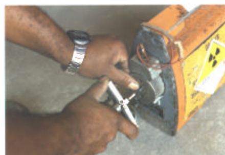
Operação de conexão da fonte de Ir-
