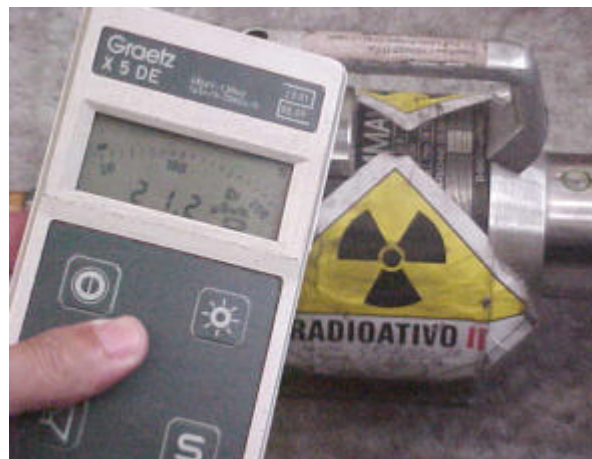
Monitoração de um irradiador gama industrial com detetor GM
