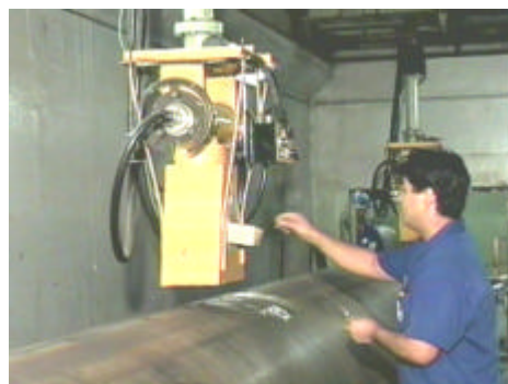
Inspeção radiográfica de soldas em tubos
