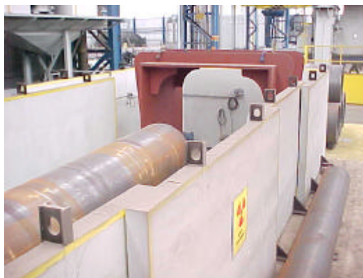
Foto de uma instalação aberta para radiografia de tubos de aço com espessuras de 20 até 50 mm, usando fontes de Raios X e Ir-192.
