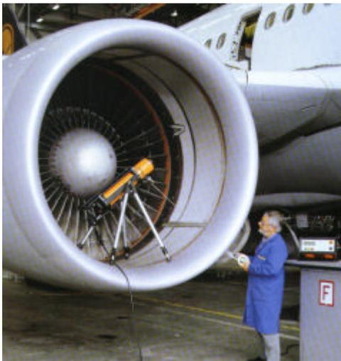
Técnico de uma companhia aérea preparando a inspeção radiográfica da turbina do avião, utilizando um aparelho de Raios X. A inspeção radiográfica das aeronaves em operação é uma ferramenta indispensável para controlar os componentes , e verificar se os mesmos permanecem na mesma condição de fabricação.
