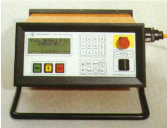
A foto ao lado representa uma unidade de comando de um aparelho de Raios X industrial moderno. O painel, digital, resume uma série de informações técnicas sobre a exposição, tais como distância fonte-filme, kilovoltagem, miliamperagem, tempo de exposição. As informações no display poderá ser memorizada e recuperada quando necessário.
