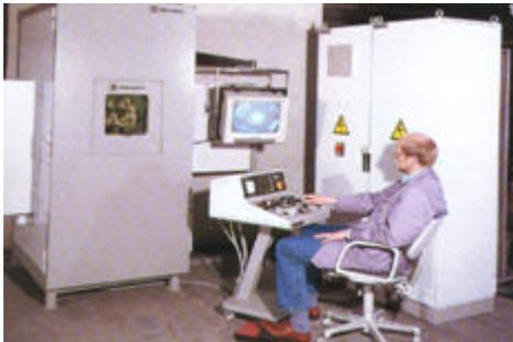
Sistema de radioscopia com câmara de TV transmitindo a imagem para uma monitor. O inspetor analisa a imagem radioscópica da peça, controlando os parâmetros de exposição aos Raios X.
