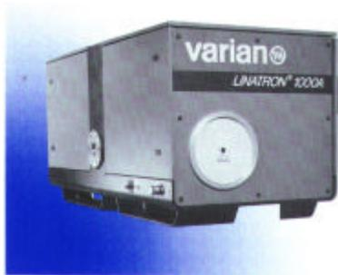
Acelerador linear industrial, para radiografias de peças com espessuras acima de 100 mm de aço. Projetado para produzir um feixe de radiação de 4 Mev, com ponto focal bastante reduzido de 2 mm, produz uma taxa de dose de 2,5 Gy/min a 1 m operando com 2 Mev, e 0,25 Gy/min com 1 Mev.. Produz filmes com alta qualidade, mesmo em altas espessuras.
