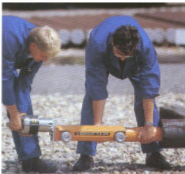
A foto ao lado mostra um equipamento especial para radiografias de tubulações pela técnica de PS-VS, denominado de Crawler. O equipamento é introduzido dentro da tubulação, por onde percorre toda sua extensão, parando nos pontos onde a radiografia será feita. O controle da movimentação do equipamento é feita pelo lado externo da tubulação, remotamente.
