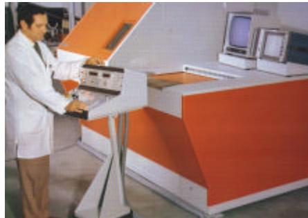
Aparelho para radioscopia industrial, dotado de câmara de TV e monitor de vídeo para observação das imagens. Equipado com uma unidade de Raios X de 160 kV e 20 mA, é específico para inspeção de peças de ligas leves de alumínio e magnésio.
