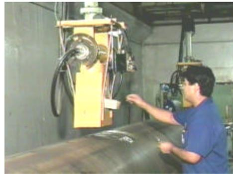
Inspeção radiográfica de soldas em tubos
