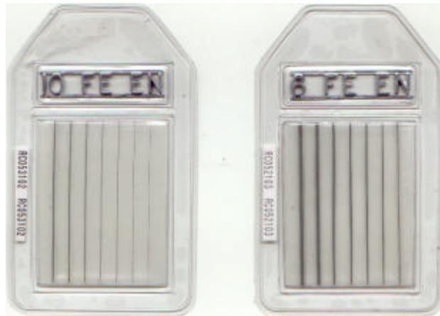
IQI conforme a norma EN-462 Parte 1 (antiga DIN 54109 Part 1)
